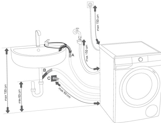
**A** Il tubo di scarico può essere collocato nel lavandino o nella vasca da bagno. Fissare il tubo con una corda che deve passare nell'incavo del supporto in modo che il tubo non scivoli a terra.
