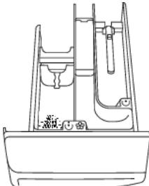
4. Nel cassetto del detersivo aggiungere la quantità raccomandata di detersivo in polvere o liquido. A titolo indicativo, osservare l'indicazione della quantità/livello di detersivo nello scomparto del detersivo per il lavaggio (vedere il capitolo »CONSIGLI PER UN LAVAGGIO E UN USO ECONOMICO DELLA LAVATRICE«).
