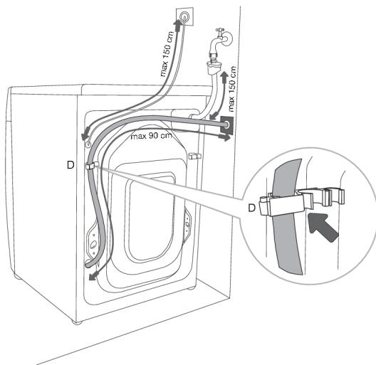
**D** Il tubo di scarico deve essere fissato e bloccato dietro il perno sulla parete posteriore della lavatrice, come mostrato nell'illustrazione.
