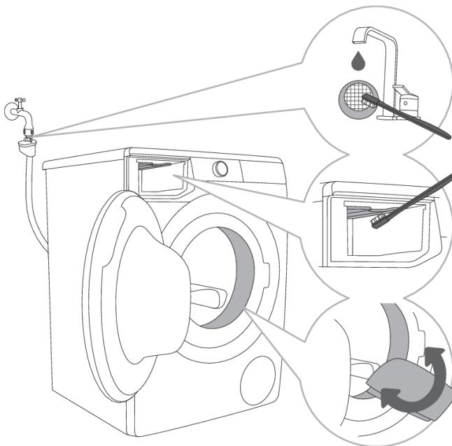
**1** Pulire più volte la rete del tubo di alimentazione idrica sotto l'acqua corrente.
