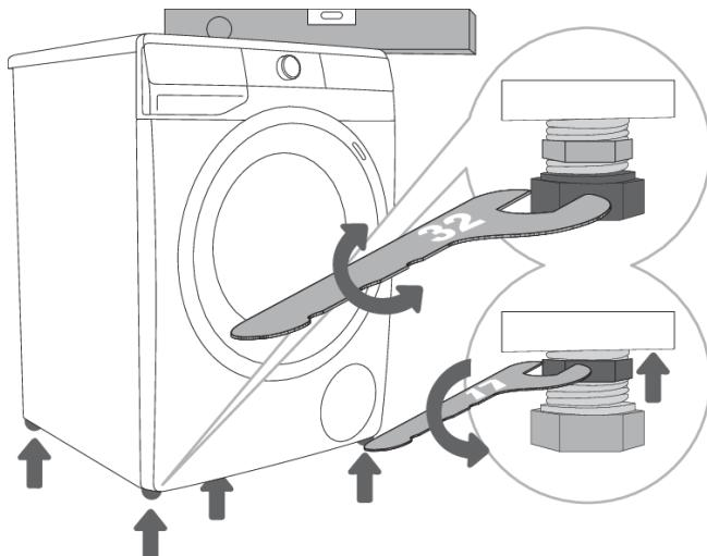
**1** Livellare la lavatrice longitudinalmente e trasversalmente ruotando i piedini regolabili.
